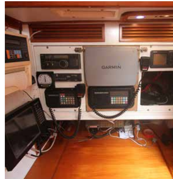
Navigationkonsollen omfatter bl.a. radar, GPS, elektronisk kort, SSB og VHF.
